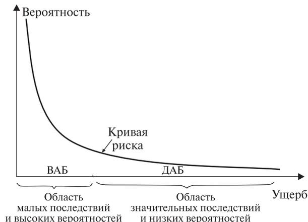
Рис. 4. Взаимодополнение вероятностного анализа безопасности и детерминистического анализа безопасности
