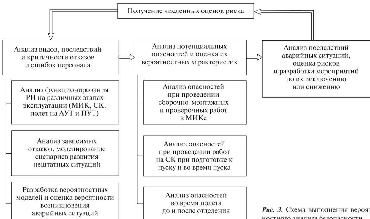
Рис. 3. Схема выполнения вероятностного анализа безопасности
