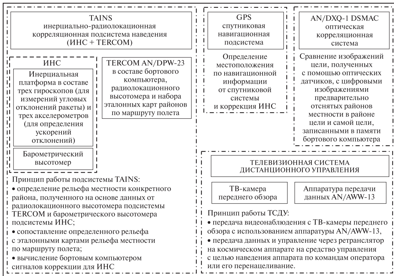
Рис. 3. Типовая схема общего вида состава и функций подсистем наведения и управления крылатых ракет
