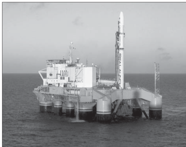
Рис. 2. Плавающий РКК «Sea Launch»
