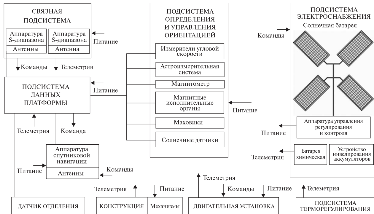
Рис. 1. Структурная схема платформы МС-2
