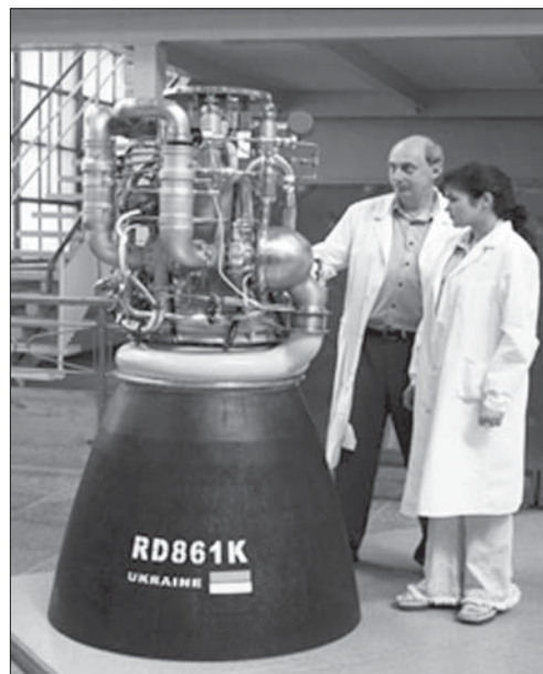
Рис. 3. Жидкостный ракетный двигатель с насадком из УУКМ
