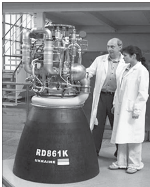
Рис. 3. Жидкостный ракетный двигатель с насадком из УУКМ
