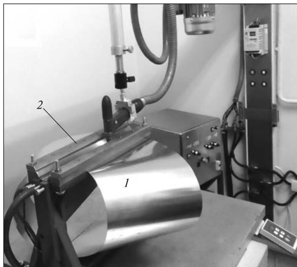
Рис. 4. Мікроплазмове зварювання тонкостінного елемента 1 (секції) конструкції перетвореного об'єму на складально-зварювальному пристосуванні 2
