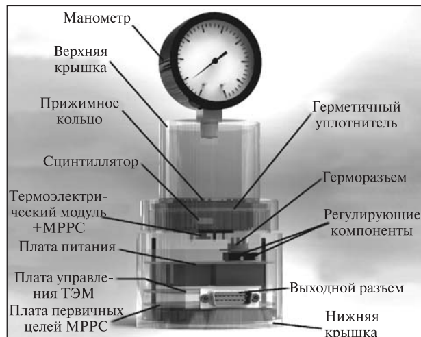
Рис. 9. Конструкционный вид компактного настольного стенда для исследования режимов работы малогабаритных органических сцинтилляционных детекторов
