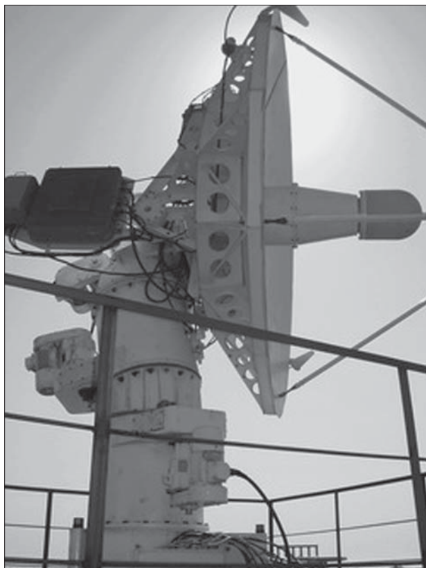
Рис. 1. Антенное устройство НС СКТРЛ МС-2 ... МС-8
