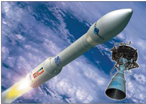
Рис. 3. Европейская РН «Вега» с маршевым двигателем верхней ступени, разработанным в КБ «Южное» и изготовленным на Южмаше
