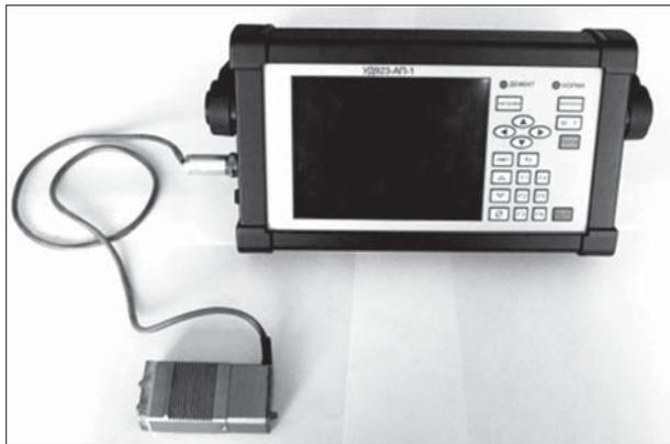
Рис. 13. Ультразвуковой дефектоскоп УД 923-АП1
