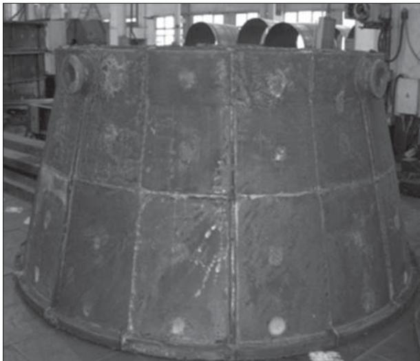
Рис. 1. Оснастка для отжига заготовок
