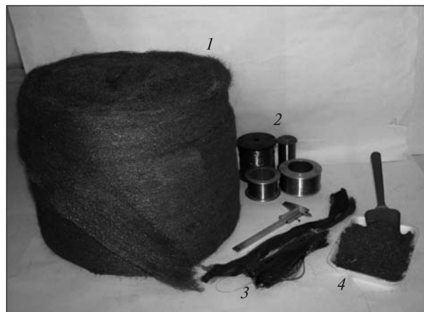
Рис. 1. Общий вид металлических волокон в состоянии поставки: 1 — бухта, 2 — катушки, 3 — жгуты, 4 — дробь (короткие волокна)
