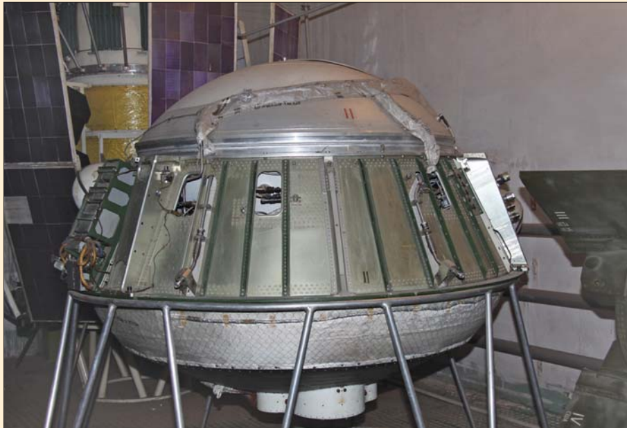
Блок Е — взлетно-посадочный модуль лунного космического корабля. Разработан КБ «Южное», изготовлен на предприятии «Южмаш»
