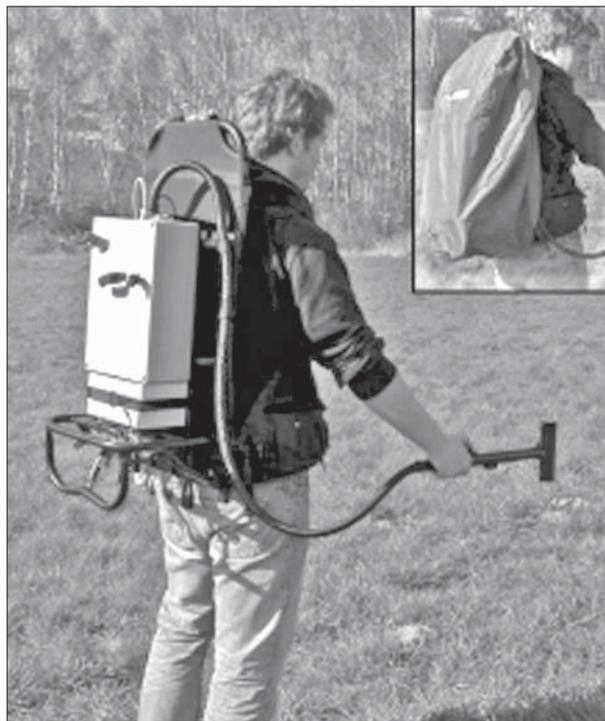
Рис. 7. Портативная система «HandySpec» в рюкзаке [39]
