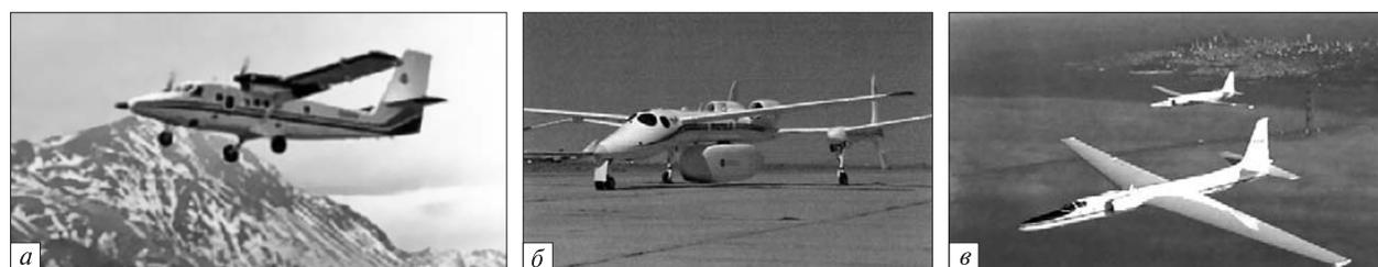
Рис. 4. Носители гиперспектрометра AVIRIS: а — самолет Twin Otter (рабочая высота полета 4 км), б — самолет New Sarability (рабочая высота полета от 5 до 8 км), в — самолеты ER-2 (рабочая высота полета до 20 км)
