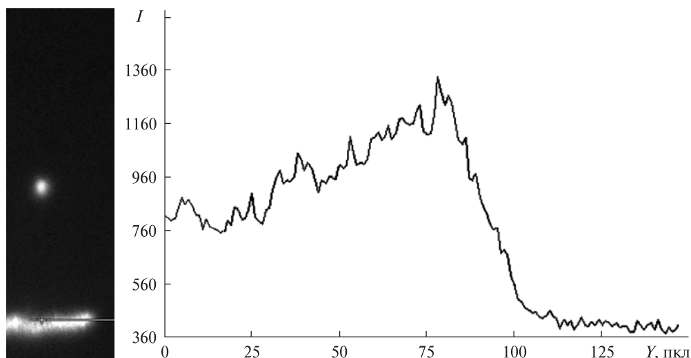
Рис. 7. Фотометричний розріз треку зорі вдовж осі X для визначення початку експозиції
