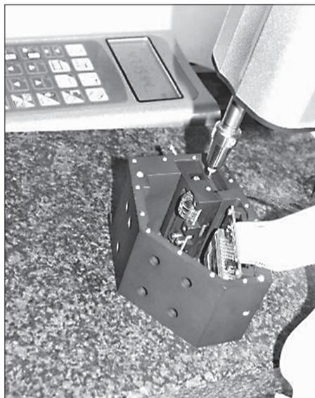
Рис. 8. Рабочее место для настройки матричного фотоприемного узла гиперспектрометра [23]
