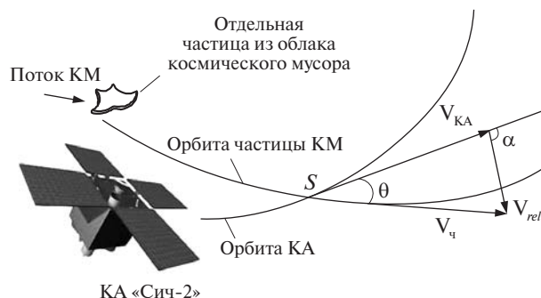
Рис. 2. Схема взаимного движения КА и отдельной частицы КМ
