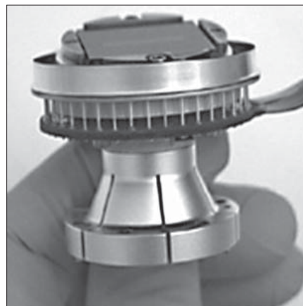
Рис. 6. Кремниевый матричный сенсор VNIR -диапазона с тепловой изоляцией и кабелями [30, 36]
