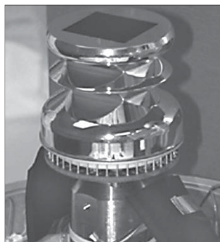
Рис. 7. Матричный КРТ-сенсор ИК-диапазона с тепловой изоляцией [36]
