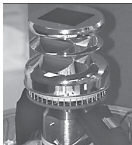
Рис. 7. Матричный КРТ-сенсор ИК-диапазона с тепловой изоляцией [36]
