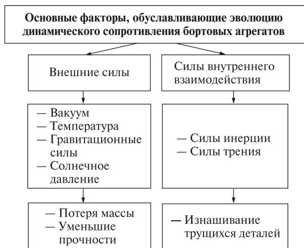
Рис. 1. Схема изменения динамического сопротивления бортовых агрегатов
