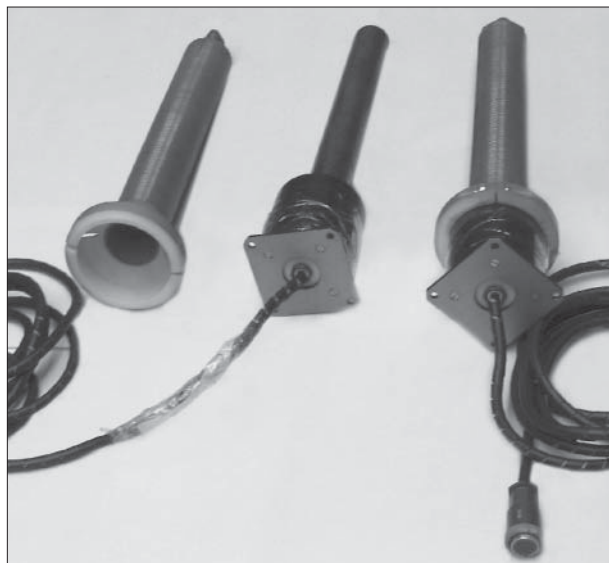
Рис. 4. Хвильовий зонд (ХЗ): зліва — захисний і випробувальний футляр, посередині — ХЗ, справа — ХЗ з футляром
