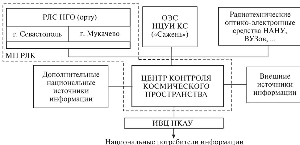
Рис. 1. Структура системы контроля и анализа космической обстановки
