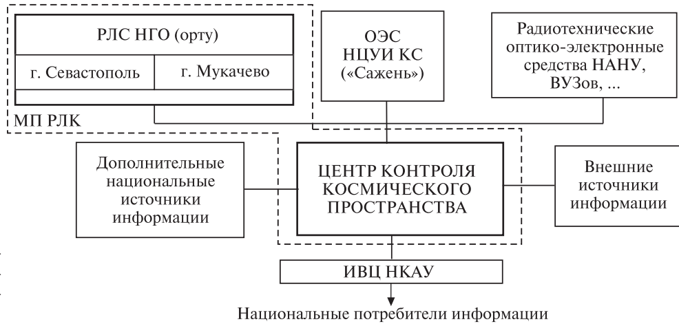
Рис. 1. Структура системы контроля и анализа космической обстановки
