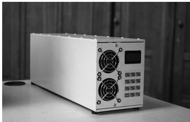
Рис. 4. Блок коррекции движения телескопа АЗТ-2
