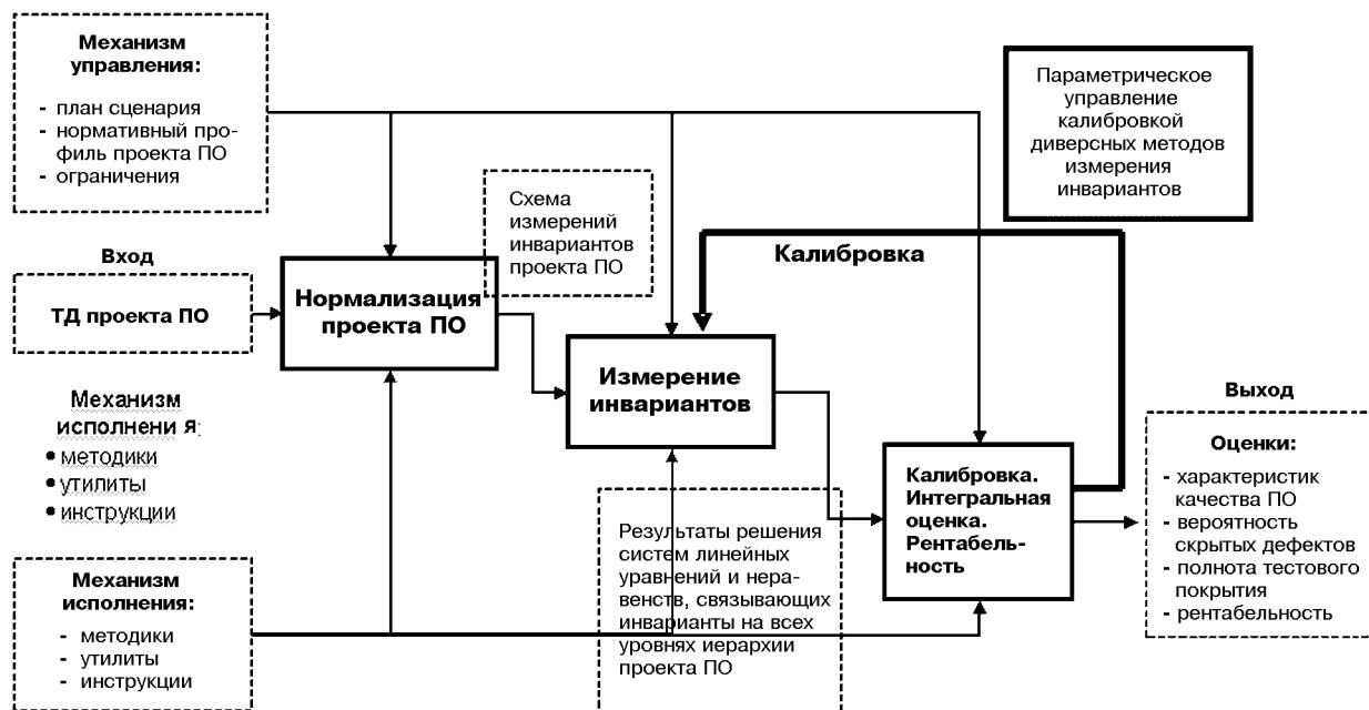
Рис. 4. Функциональная IDEF0-модель сценария независимой верификации
