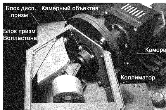
Рис. 6. Часть оптической схемы спектрометра поляриметра сопровождения на исследовательском стенде
