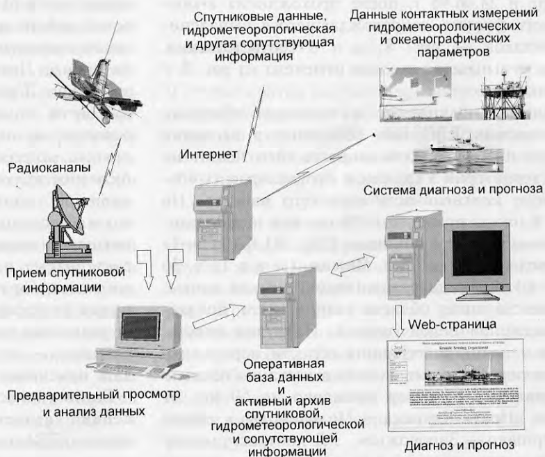
Рис. 9. Обобщенная структура системы оперативного мониторинга Черного и Азовского морей с усвоением спутниковой информации
