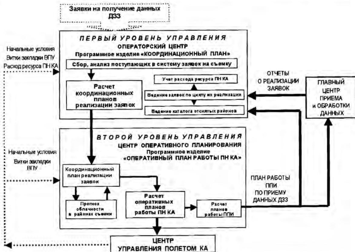
Двухуровневая система управления работой НСК космических систем по реализации заявок потребителей на получение данных ДЗЗ
