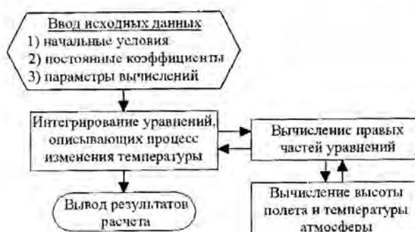
Рис. 2. Блок-схема вычислительной программы для определения температурных условий в кабинах СН
