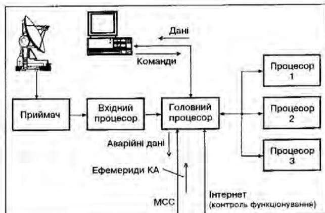
Рис. 2. Функціональна схема обробки даних в станції LEOLUT
