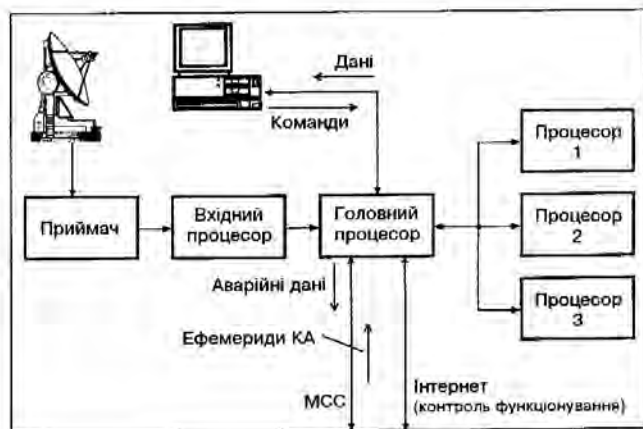
Рис. 2. Функціональна схема обробки даних в станції LEOLUT
