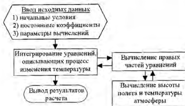
Рис. 2. Блок-схема вычислительной программы для определения температурных условий в кабинах СН
