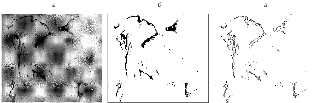
Рис. 4. Последовательность обработки радарного изображения при распознавании классов объектов: а — исходное изображение, б — обнаружение нефтяных пятен, в — выделение контуров нефтяных пятен
