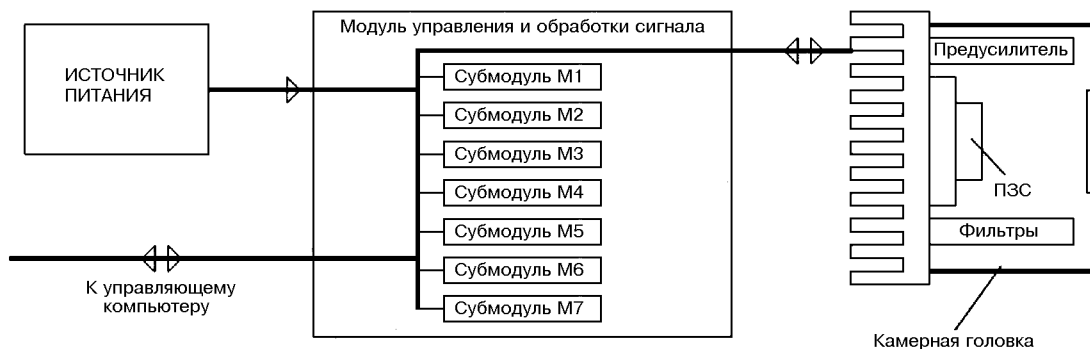
Рис. 3. Схема ПЗС-камеры НАО
