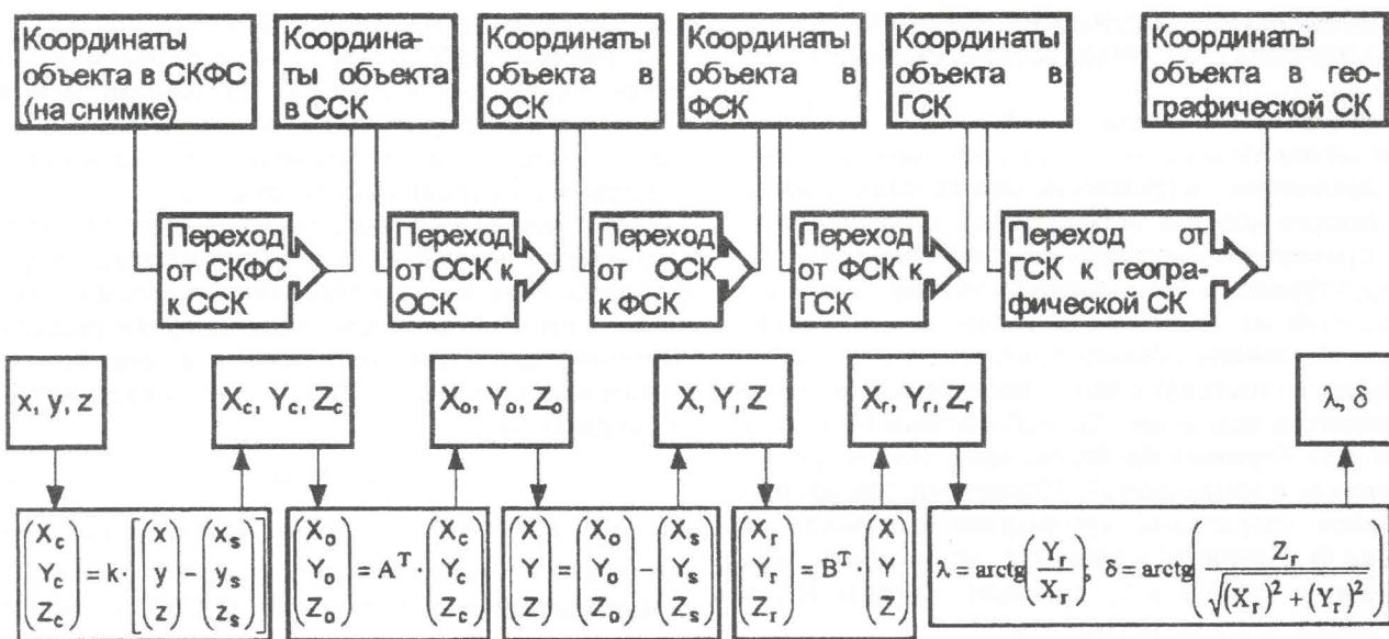
Рис. 4. Последовательность переходов при расчете координат снятого объекта на поверхности Земли: А — матрица перехода от ОСК к ССК (поворот на углы  $\theta, \varphi, \psi$ ); В — матрица перехода от ГСК к ФСК (поворот на углы  $\Omega, i, \omega$ );  $k$  — коэффициент пропорциональности;  $x_s, y_s, z_s$  — координаты центра проецирования  $S$  в СКФС;  $X_s, Y_s, Z_s$  — координаты центра проецирования  $S$  в ФСК
