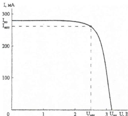
Рис. 7. ВАХ разработанного модуля фотопреобразователей
