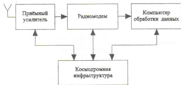
Рис. 6. Функциональная схема наземного комплекса
