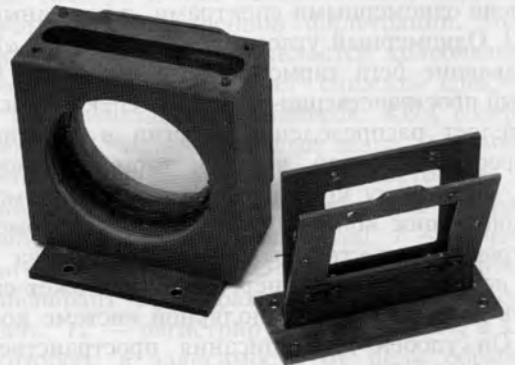
Рис. 6. Иммерсионная ячейка, совмещенная с фурье-линзой для снимков МКФ-6
