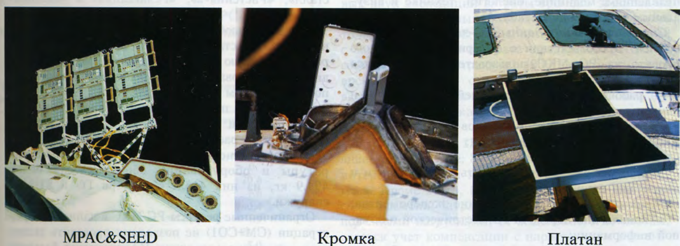
Рис. 2. Размещение научной аппаратуры на внешней поверхности служебного модуля РС МКС
