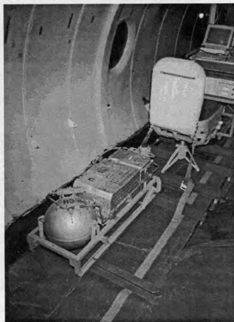
Рис. 2. Зовнішній вигляд літака АН-30 з установленим на ньому комплексом АКДЗ-30 (а); внутрішній вигляд салону з робочими місцями операторів (б); ПЧ-сканер «Малахіт-1» та аерофотоапарат, змонтовані в фотолюках літака (в); приймально-передавальний блок РБО (г)
