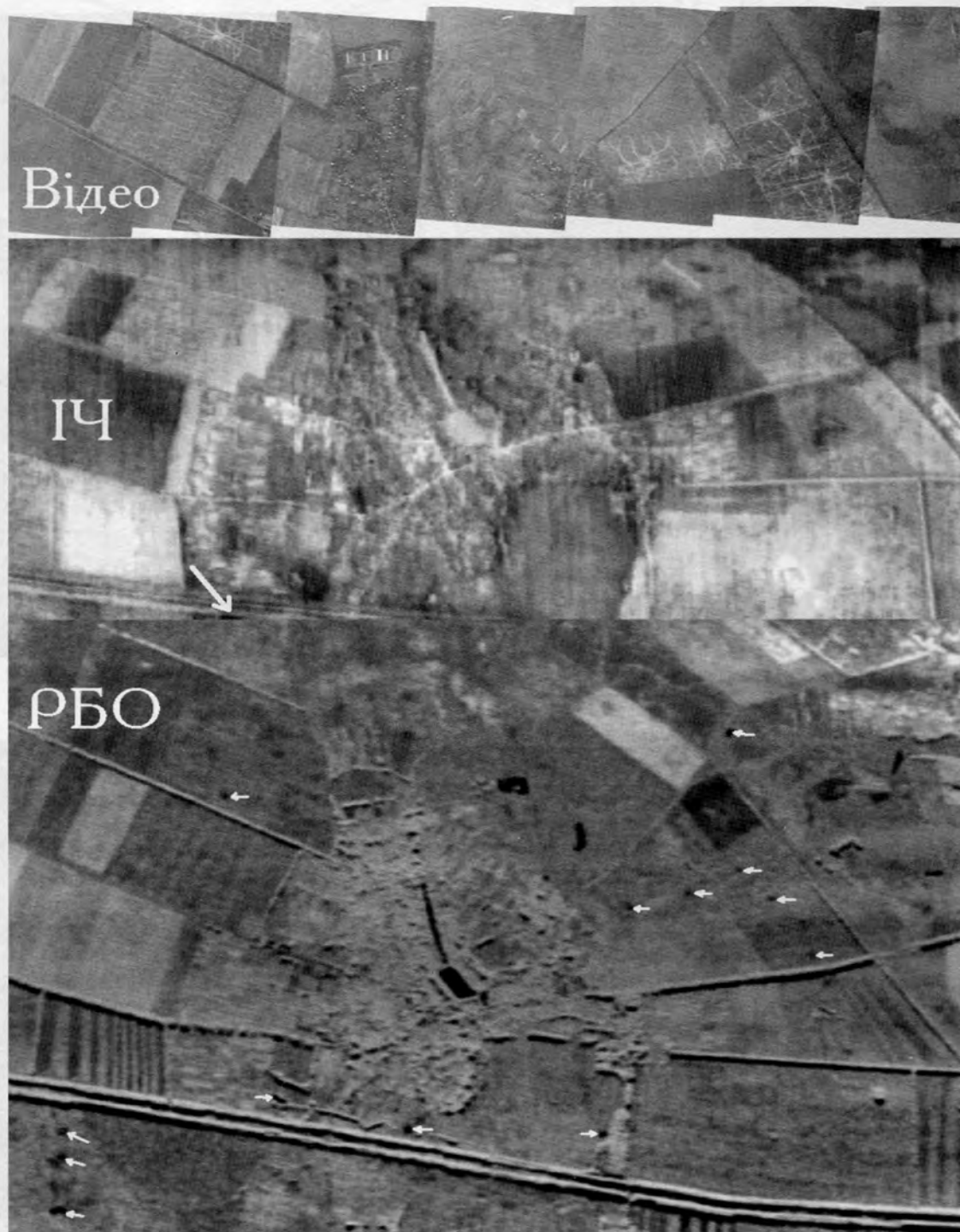
Рис. 3. Комбіноване зображення (складене з радіолокаційного, інфрачервоного та відеозображень) місцевості біля с. Добре Озеро (Ніжинський район, Чернігівська обл.), отримане за допомогою комплексу АКДЗ-30 влітку 2001 р. На радіолокаційному зображенні добре видно прояви на поверхні ґрунту підповерхневої води (маленькі стрілки), а також рослинність (навіть відрізняється стерня з різним рівнем скошування). В місці, поміченому на ІЧ-зображенні довгою стрілкою, спостерігається небезпечне підтоплення ґрунту, яке простягається під залізничну колію
