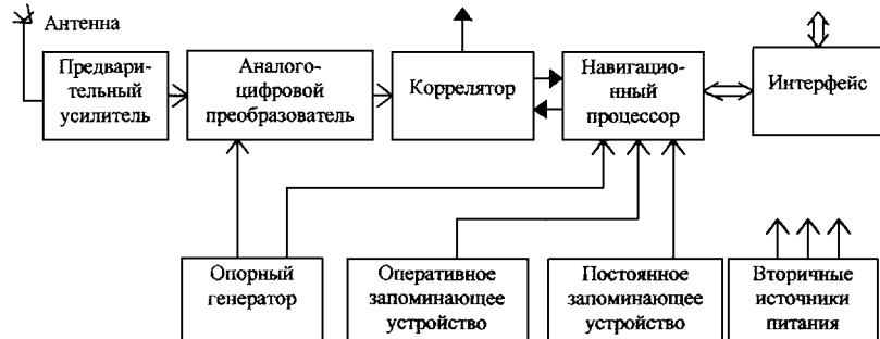
Рис. 2. Структурная схема АП SVeeSix-CM3
