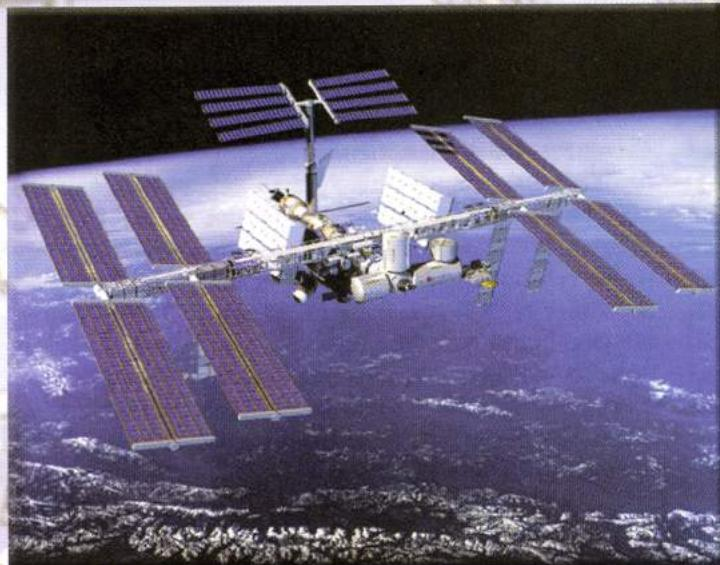
Міжнародна космічна станція (МКС) – визначний міжнародний проект, в основу якого покладено нові ідеї монтажу і функціонування орбітальних космічних станцій. Монтаж МКС на орбіті розпочався 1998 р. запуском функціонального вантажного блоку "Заря" (Росія) та наступним стикуванням з блоком "Unity" (США).
