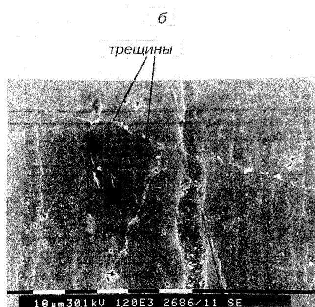
Рис. 2. Топография поверхности серебряных покрытий, полученных в наземных (а) и космических (б) условиях
