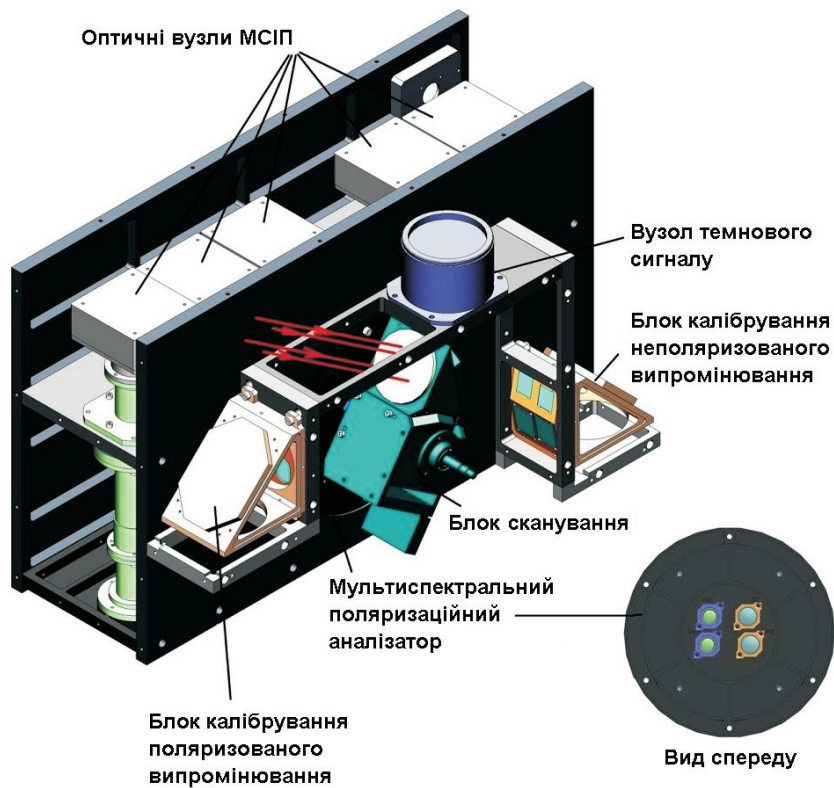
Рис. 2. Геометричне розташування вузлів калібрування «СканПол» та вхідного отвору для калібрування по сонячному випромінюванню, червоними лініями позначено промені, що спрямовуються для калібрування на вхід блоку сканувальних дзеркал
