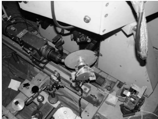
Рис. 1. Розташування модулятора на вузлах телескопа
